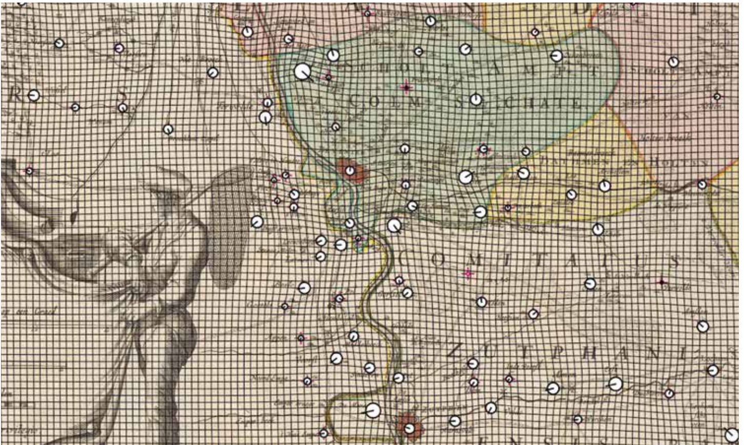
20. Het vervormingsgrid laat een matige afwijking zien.
